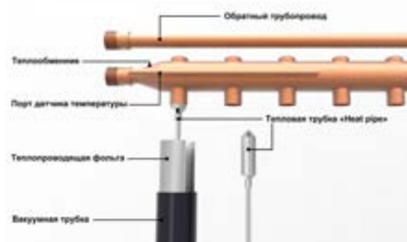
Рис 3. Конструкция теплообменника солнечного вакуумного коллектора
